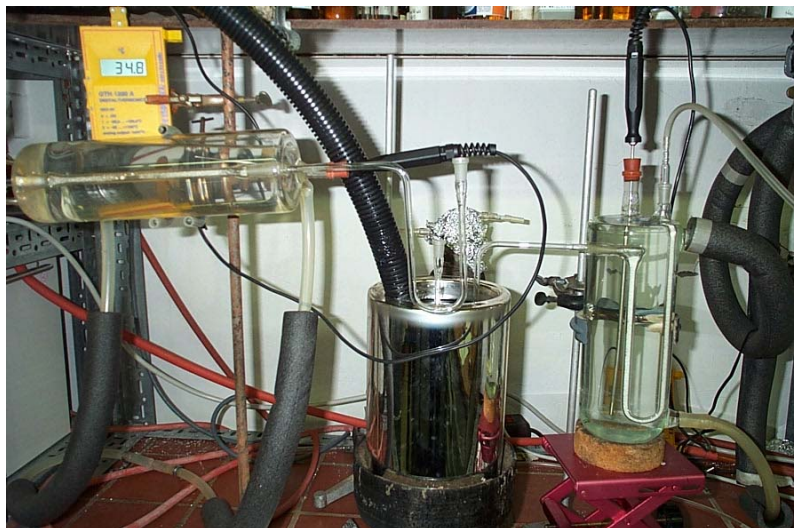
Figure. 1. Schema der Apparatur zur Durchführung des Transpirationsexperimentes. (1) Trägergasflasche; (2) Präzisionsnadelventil; (3) Durchflussmesser; (4) thermostatisierte Messzelle; (5) U-Rohr, gefüllt mit der Probe; (6) Thermometer; (7) Kühlfalle, T = -30^\circ\text{C} .
